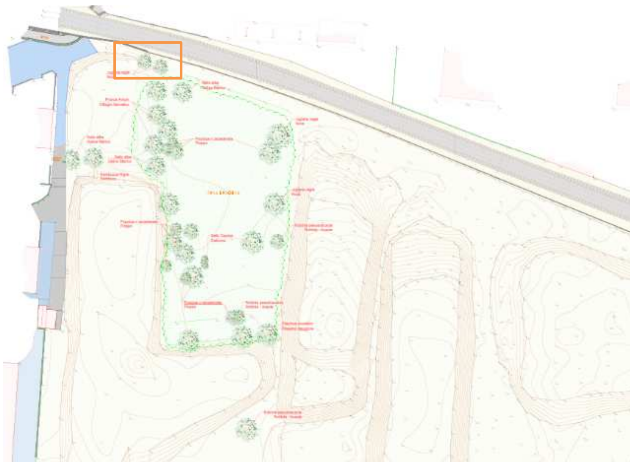
Figura 54. Estratto del rilievo con individuazione degli esemplari da abbattere. I due esemplari di Noce nel riquadro arancione verranno mantenuti
